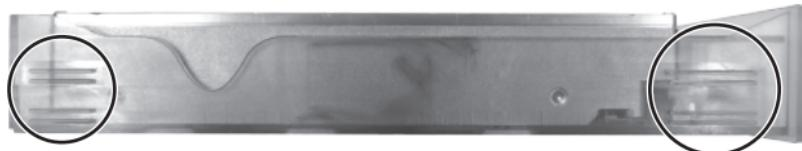
⑦HDD 搭載用ケースと筐体のガイドの位置を合わせながら矢印の方向にスライドさせてください。
