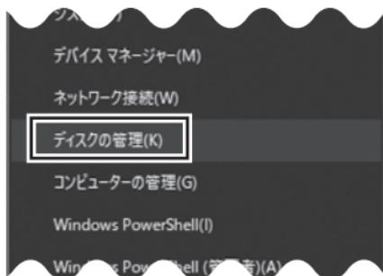
②初期化が行われていないHDDをパソコンに接続していた場合、「ディスクの管理」を選択した際に、「ディスクの初期化」が表示されます。
